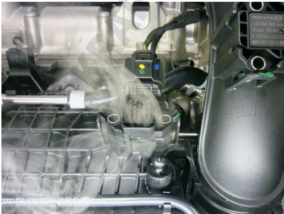
Rauchzeichen: Mit dem Einsatz von Rauchgas kann der Mechaniker vorhandene Undichtigkeiten beispielsweise im Ansaugtrakt prüfen, wie dieser Demonstrationsaufbau zeigt. Bild: Star Enviro Tech
