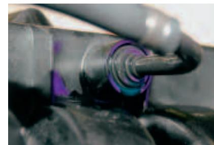
**Farbkennzeichen:** Undichtigkeiten erkennt der Fachmann anhand des per ultraviolettem Licht aktivierten fluoreszierenden Färbemittels im Rauchdunst. Bild: Guranti
